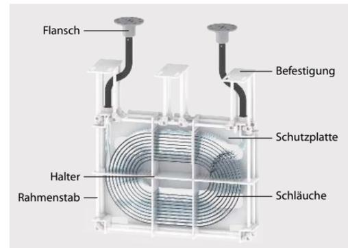
Der Abstand zwischen Befestigung und Wärmetauscher-Körper, bzw. die überstehende Stablänge kann dabei kundenspezifisch gewählt werden.
