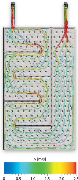
Für das Beheizen können Heißwasser, Dampf, Satttdampf und Thermoöl als Wärmetauschermedium verwendet werden. Zum Kühlen eignen sich Wasser, Salzlösungen und Glykol.
